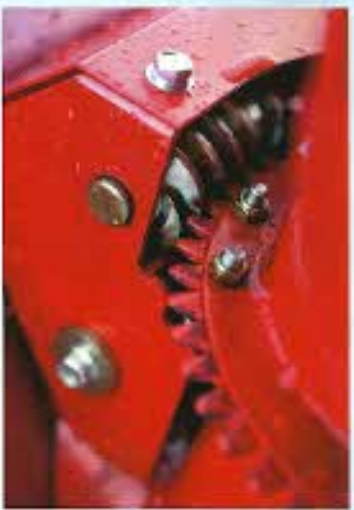
Heittotorvea kääntelee molemmissa sähkömoottori, joka pyörittää matopyörää hammaskehää vastaan.
